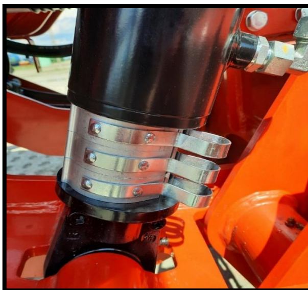
Rys. 75. Klipsy zabezpieczające na siłownikach
