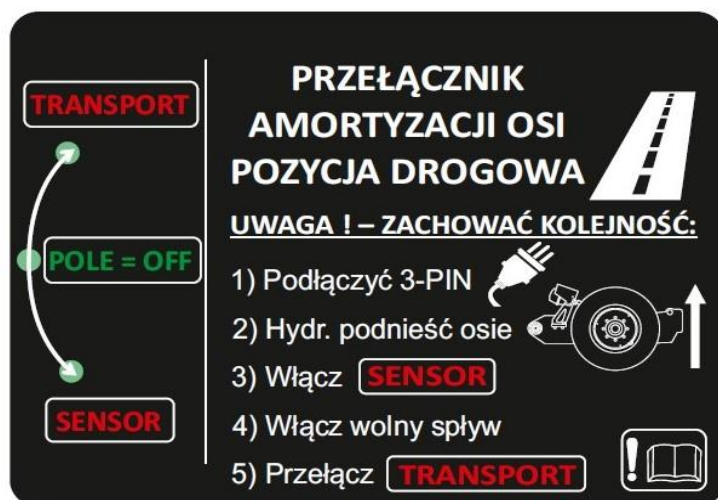
Rys. 51. Sterownik amortyzacji – pozycja drogowa
